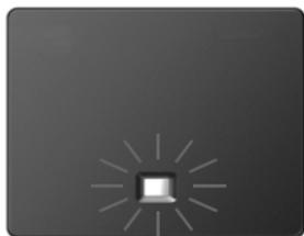
После подключения кабеля к телефону и маршрутизатору и включения маршрутизатора загорается подсветка кнопки на передней панели базового блока (кнопка пейджинга).
